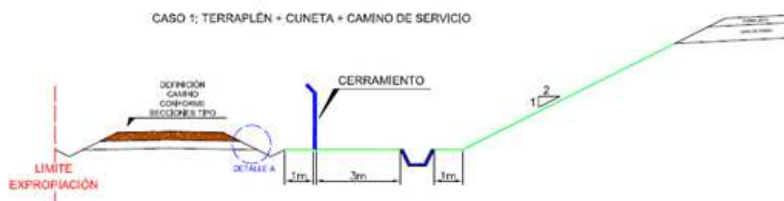
Obrázek 11: Vzorový řez umístění oplocení mezi obslužnou komunikací a násep VRT.
