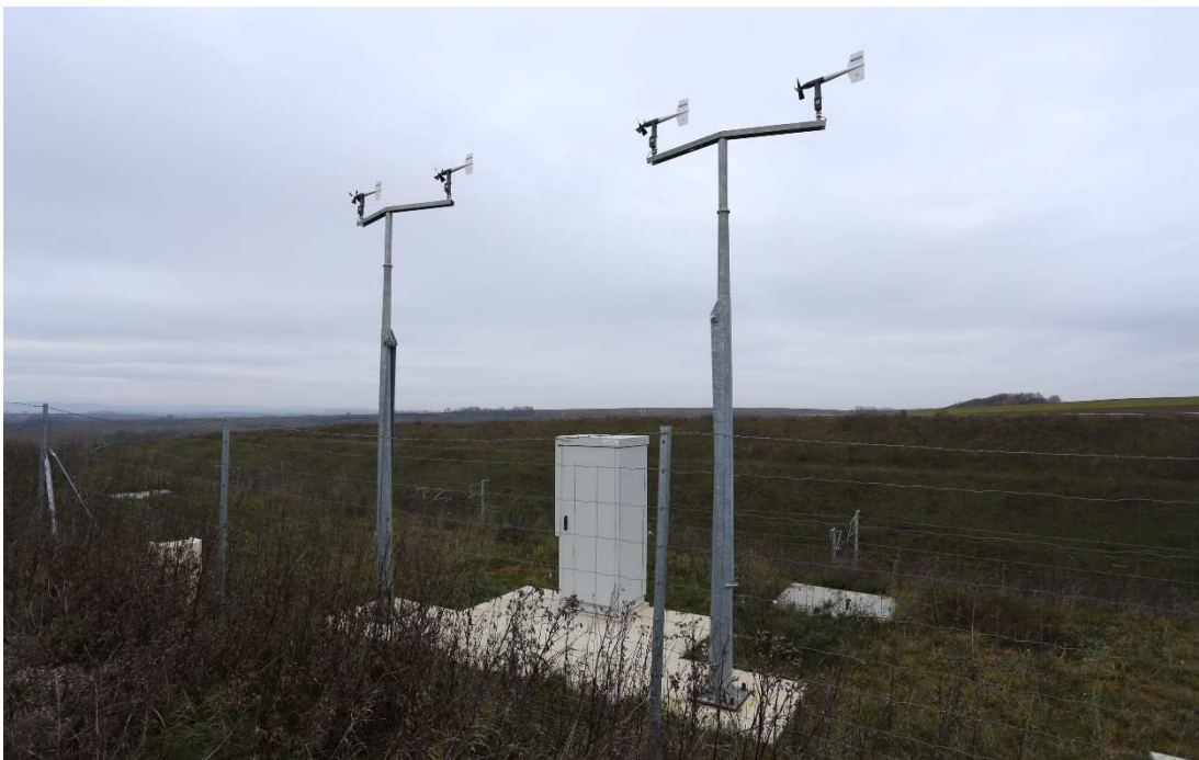
Obrázek 26: Indikátor rychlosti větru na LGV Est.
