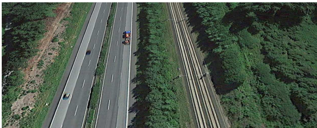
Obrázek 3: VRT Frankfurt – Köln odděluje od dálnice zelený pás, šířka vysokorychlostní trati je menší než jeden směr dálnice.
